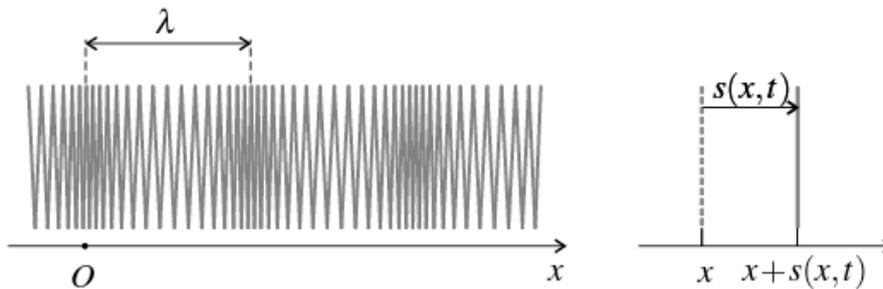
1. On appelle  $a$  l'espacement entre deux spires consécutives dans l'état de repos. Lors du passage de l'onde, la distance entre les spires situées au repos en  $x_i = ia$  et  $x_{i+1} = (i+1)a$  devient  $d_i$ . Exprimer  $d_i$  en fonction de  $a$ ,  $s(x_i,t)$  et  $s(x_{i+1},t)$ .
